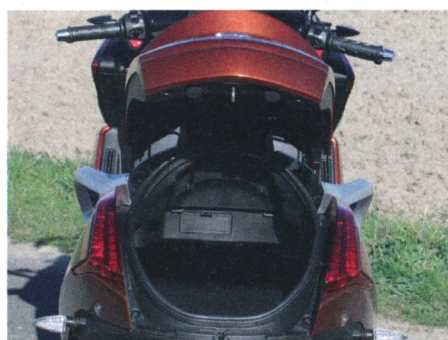
Doppelter Zugang ins Steufach über das Öffnen der Sitzbank oder wie beim Pkw übers Heck.
